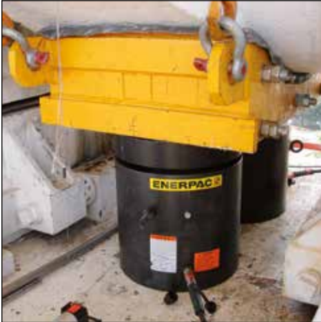
▲ Raskas nostaminen ja perustusten tasaaminen. Lukkomutteri tarjoaa pitkäaikaisen mekaanisen kuorman pidon.
