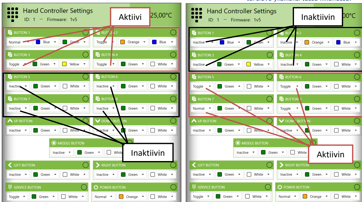
Kuva 59 Esimerkki, jossa vasemmalla olevalla master-yksiköllä on aktiiviset toimintopainikkeet 1-4, kun taas oikealla olevalla slave-yksiköllä on aktiiviset toimintopainikkeet 5-8.
