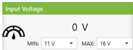
Kuva 51 – Relerasian sallittu jännitealue voidaan asettaa myös Yksikön Tila -ikkunassa
